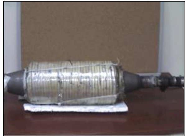
Şekil 2.2. İndüksiyonlu Akışkan Isıtıcısı Deney Sisteminin Kovan Kısmı
