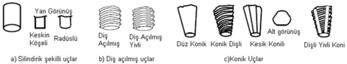
Şekil 4.10 SKK kaynak takımı karıştırıcı uç kısmı geometrilere ait örnekler [49].
