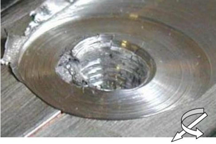
Şekil 4.18 SKK kaynak takımının çıkış noktasında pimin yukarı çekilmesiyle oluşan anahtar deliği [54].
