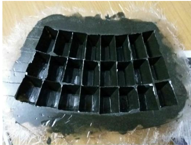
Şekil 4. Model kullanılarak hazırlanan polimer kompozit döküm kalıbı
